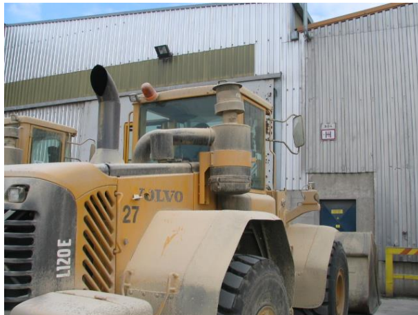
Slika 2: Pravilna postavitev filtra – TAKO NAJ BO POSTAVLJEN
